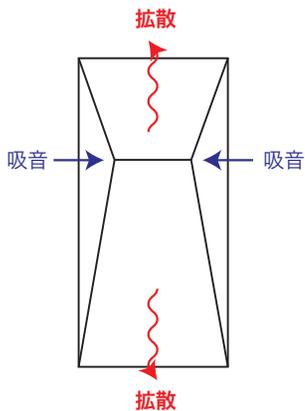
テクニカル・サウンドの拡散吸音パネルは、部屋の響きを上下に効果的に拡散させ、音の広がりを向上させる設計となっています。
