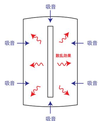
パネルのR部分は、低域から高域までの音波を効果的に散乱させ、センターの隙間および周囲の隙間を通じて不要なノイズを吸音します。
