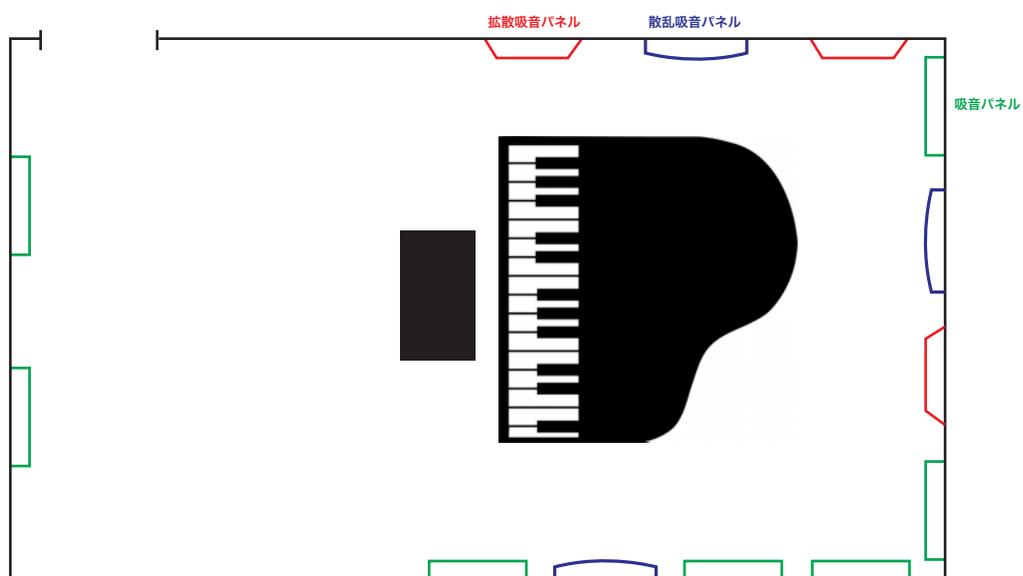
各種吸音パネルを組み合わせる事で、部屋全体の響きを最適化します。
